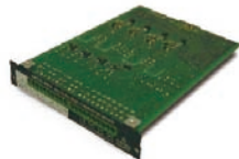
電圧・サーモメータユニット [OP01-PFX]
