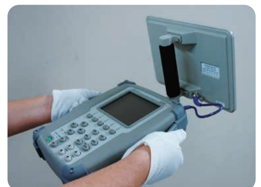
▼アンテナを装着した状態
