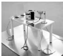
静電気放電試験 環境設備 (試験テーブル他)
