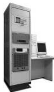
電圧ディップ・瞬停・電圧 変動イミュニティ試験システム IT01-PCR-L他
